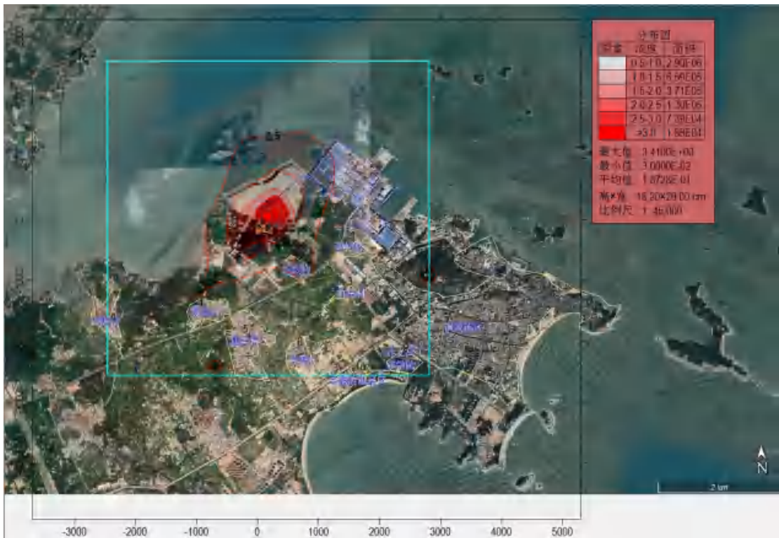
图 5.2.7 非正常排放氟化物日均值质量浓度等值线分布图单位: \mu\text{g}/\text{m}^3
