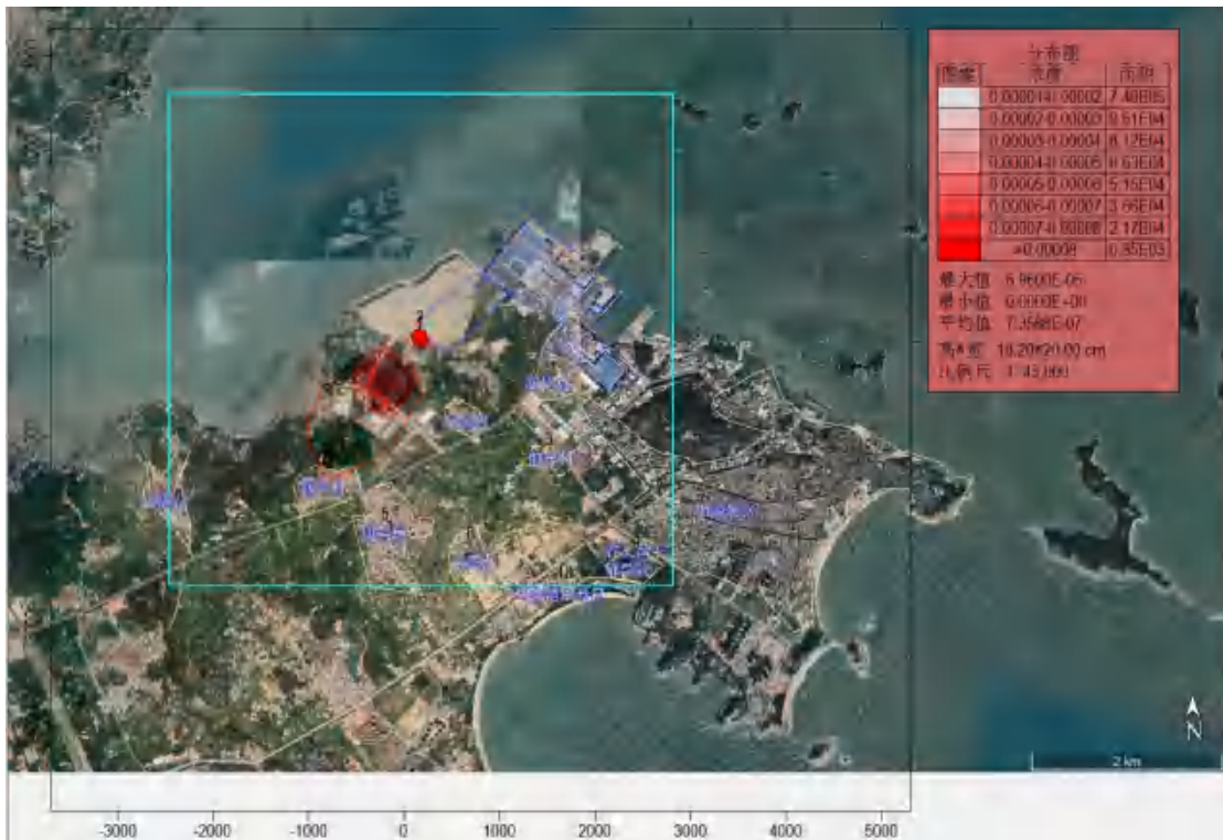
图 5.2.11 正常排放非甲烷总烃小时均值质量浓度等值线分布图单位: \mu\text{g}/\text{m}^3
